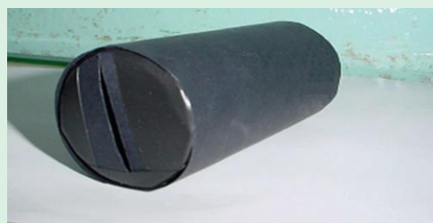
Figura 3 - Espectroscópio caseiro simples (BROCKINGTON, 2005)
