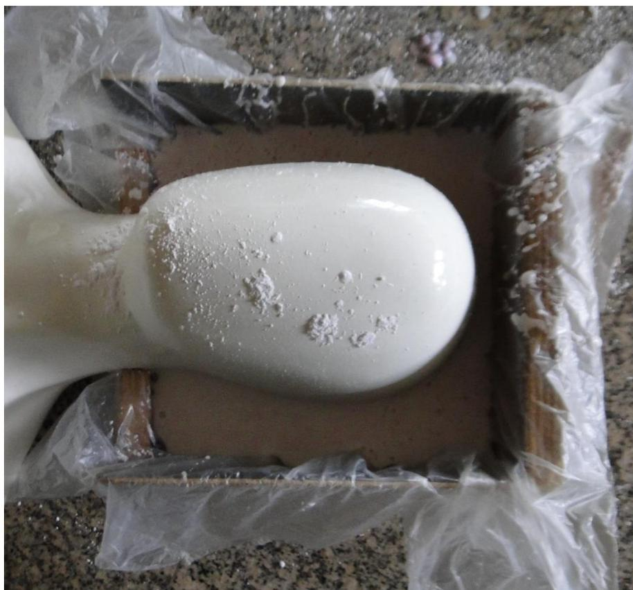
Após a obtenção dos moldes, iniciou-se a fabricação do OS. Para sua construção foi utilizado 454g de alginato, 2,70 kg de resina acrílica e 900mL de metacrilato de metila, que foram misturados em pequenas quantidades, sempre na proporção de três partes de pó para uma parte de líquido, conforme o indicado pelo fabricante. Depois de realizada a mistura que é exotérmica, aguardou-se aproximadamente 3 minutos para que a mistura passasse do estado
