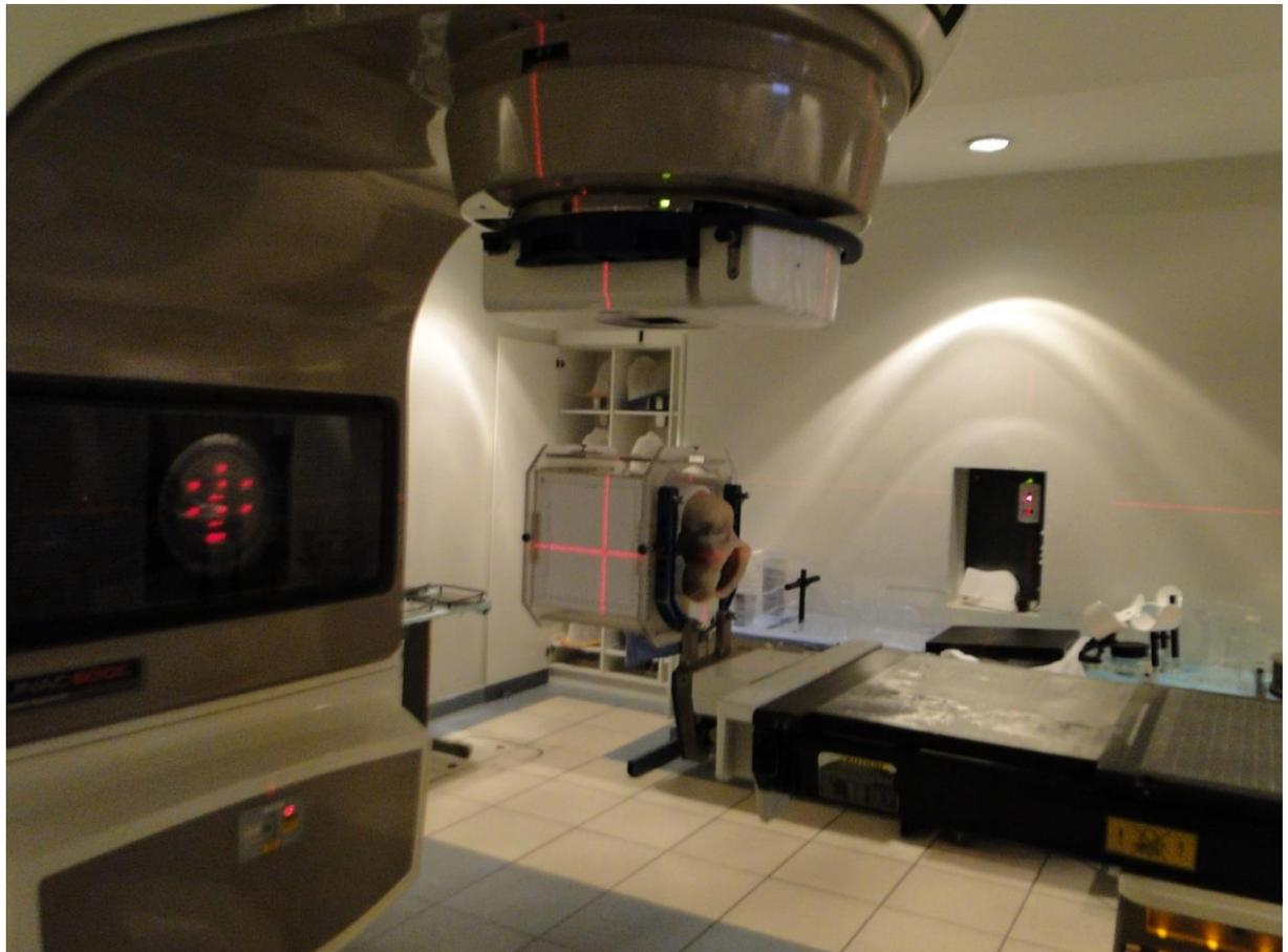
Para determinação da curva de calibração foram utilizadas dez cubetas de acrílico com dimensões  $12,5 \times 12,5 \times 4,5 \text{ mm}^3$  preenchidas com o FXG. Estas foram irradiadas em campo  $10 \times 10 \text{ cm}^2$  com as seguintes doses: 4Gy, 8 Gy, 16 Gy e 20 Gy, foram utilizadas duas cubetas para cada faixa de dose deliberada. A fig. 21 apresenta o posicionamento das cubetas para a irradiação.
